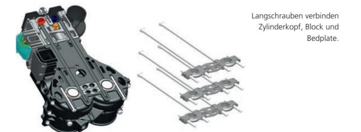
Langschrauben verbinden Zylinderkopf, Block und Bedplate.
