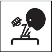
Wenn der Verschlussdeckel nicht verschlossen ist, kann heißer Dampf und Wasser entweichen, was zu Verbrennungen führen kann.
