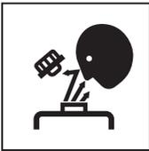
Niemals den Einfüllverschluss des Kühlmittel-tanks öffnen, solange der Motor noch heiß ist. Dampf und heißes Wasser können herausspritzen und schwere Verbrennungen verursachen. Warten Sie, bis die Temperatur des Kühlmittel-tanks gesunken ist, und wickeln Sie dann ein Tuch um den Einfüllverschluss, bevor Sie diesen langsam öffnen. Nach der Überprüfung den Einfüllverschluss wieder fest verschließen.
