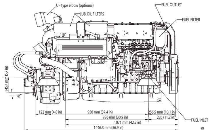
6LY3-UTP mit Yanmar KMH61A Schiffsgetriebe
