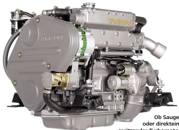
Der Yanmar 6BY260 auf BMW-Basis schöpft aus sechs Zylindern eine Leistung von 191 kW (260 PS)
