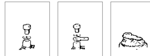
A Schraube M4 x 5 B Schraube M4 x 5 Steckanschluss 6,3 x 0,8 mm C Steckanschluss 6,3 x 0,8 vernietet
